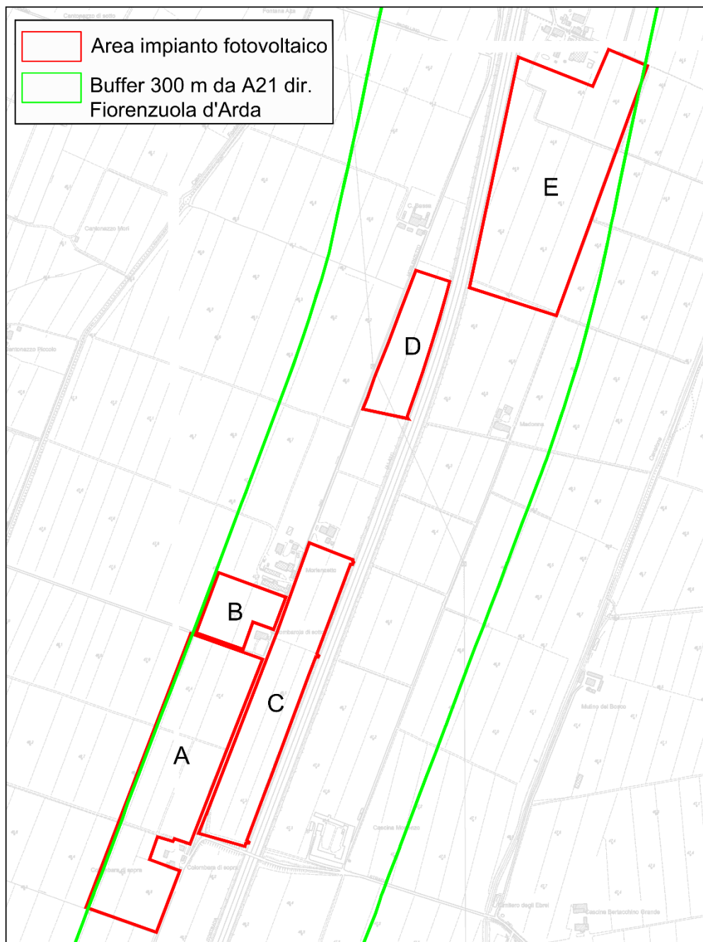
Figura 5: Localizzazione dell'impianto fotovoltaico di progetto e buffer di 300 m di cui all'art. 20, comma 8, c-ter, punto 3 del D.Lgs. n.199/2021 e ss.mm.ii. Nell'immagine sono distinti i 5 settori (A, B, C, D, E) che compongono l'impianto (fuori scala).
