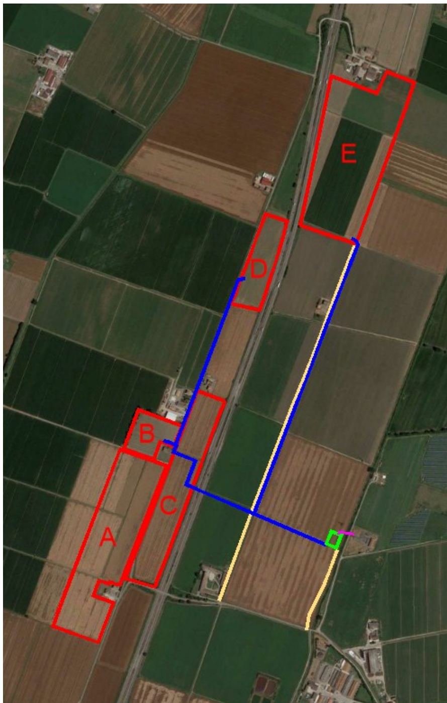
Figura 1: Inquadramento su foto aerea dell'area di progetto (fonte: Google Earth ®). In rosso sono indicate le aree in disponibilità per la realizzazione dell'impianto fotovoltaico, in blu la linea interrata di connessione elettrica MT, in verde l'area della sottostazione elettrica, in magenta la linea di connessione AT e in giallo le servitù di accesso.
